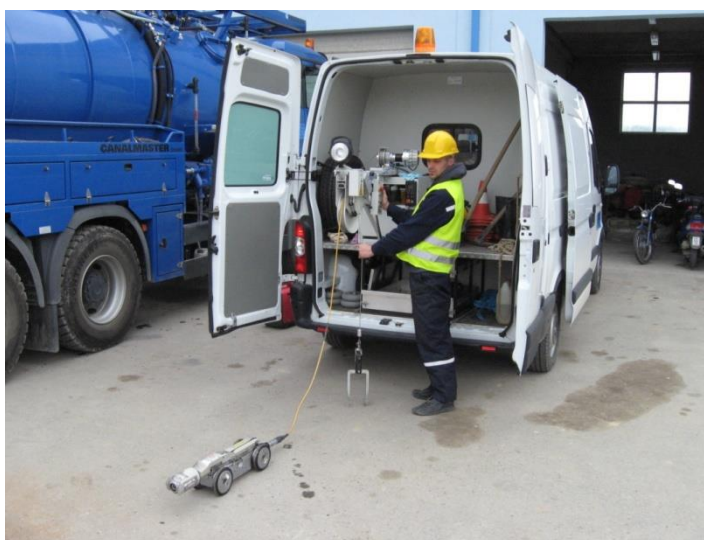
Oprema za CCTV inspekciju kanalizacijskih cjevovoda
