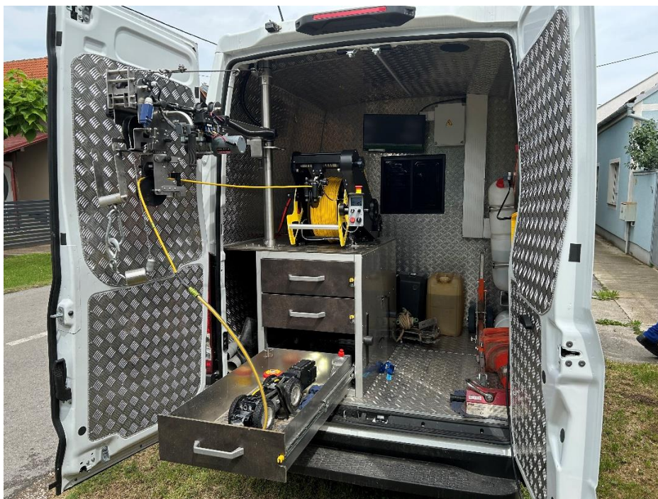
Oprema za CCTV inspekciju kanalizijskih cjevovoda
